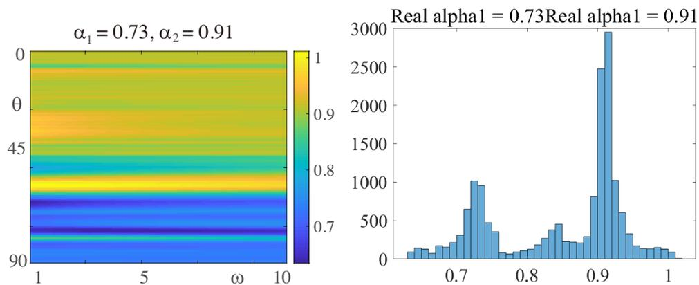
図 9: バーバラさんの一部とその縦 0.73 倍, 横 0.91 倍を Mellin 変換する. 左:  $\alpha$  を角度  $\theta$ ,  $\omega$  に対して計算した図. 右: 左図の  $\alpha$  の分布状態. 縦方向の  $\alpha_1 = 0.73$  倍と横方向の  $\alpha_2 = 0.91$  倍が現れる.
