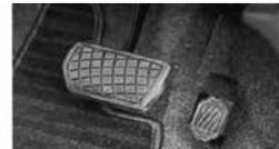
図 4 - ブレーキペダルとアクセルスイッチ例
